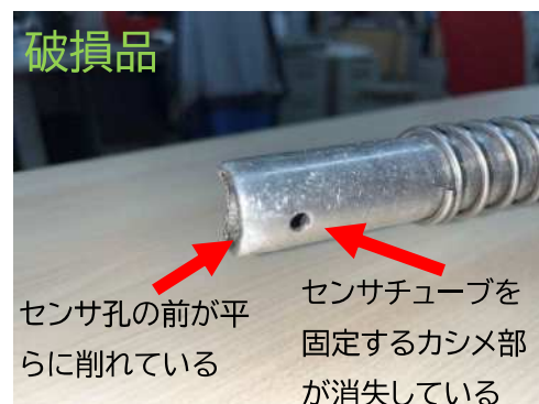
写真4 給油ノズル先端（下方）の比較
