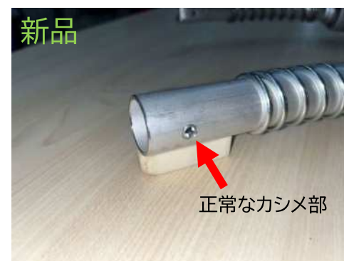
写真4 給油ノズル先端（下方）の比較
