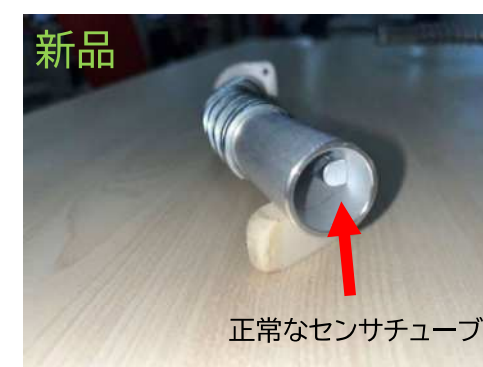
写真5 給油ノズル先端（内部）の比較
