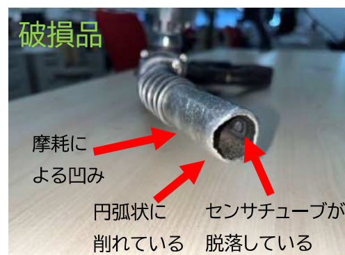
写真5 給油ノズル先端（内部）の比較
