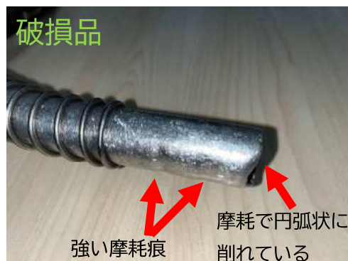
写真3 給油ノズル先端（上方）の比較
